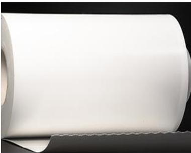
La referencia 9430 es una cinta adhesiva de doble cara, con un espesor de 380  $\mu\text{m}$ . Está compuesta por una espuma suave reforzada con un film de poliéster; el adhesivo es acrílico diferencial, especialmente desarrollado para cada uno de los lados. El lado polímero tiene adhesivo reforzado. Cuenta con un revestimiento para evitar la formación de burbujas.
