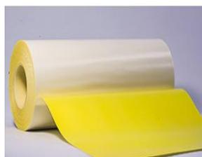
La referencia 9525 es una cinta adhesiva de doble cara, con un espesor de 550  $\mu\text{m}$ . Está compuesta por una espuma suave reforzada con un film de poliéster; el adhesivo es acrílico diferencial, especialmente desarrollado para cada uno de los lados. El lado polímero tiene adhesivo reforzado. Cuenta con un revestimiento transparente para evitar la formación de burbujas.
