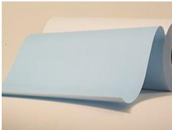
La referencia 9540 es una cinta adhesiva de doble cara, con un espesor de 550  $\mu\text{m}$ . Está compuesta por una espuma suave reforzada con un film de poliéster; el adhesivo es acrílico diferencial, especialmente desarrollado para cada uno de los lados. El lado polímero tiene adhesivo reforzado. Cuenta con un revestimiento transparente para evitar la formación de burbujas.
