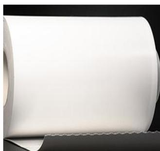
La referencia 9525 es una cinta adhesiva de doble cara, con un espesor de 550  $\mu\text{m}$ . Está compuesta por una espuma suave reforzada con un film de poliéster; el adhesivo es acrílico diferencial, especialmente desarrollado para cada uno de los lados. El lado polímero tiene adhesivo reforzado. Cuenta con un revestimiento transparente para evitar la formación de burbujas.
