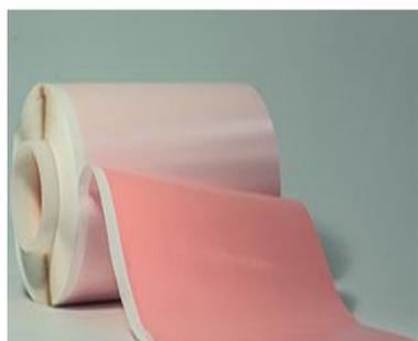
La referencia 9520 es una cinta adhesiva de doble cara, con un espesor de 550  $\mu\text{m}$ . Está compuesta por una espuma suave reforzada con un film de poliéster; el adhesivo es acrílico diferencial, especialmente desarrollado para cada uno de los lados. El lado polímero tiene adhesivo reforzado. Cuenta con un revestimiento transparente para evitar la formación de burbujas.
