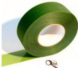
Es una cinta biadhesiva de **200 micras** de espesor, con soporte de **PVC rígido transparente**, con un adhesivo de caucho con **alta adhesividad**. El producto se presenta protegido con liner verde de PVC. **Excelente reposición y desprendimiento**.
