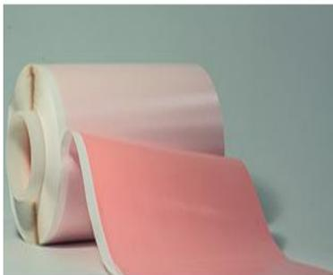
La referencia 9420 es una cinta adhesiva de doble cara, con un espesor de 380 µm. Está compuesta por una espuma suave reforzada con un film de poliéster; el adhesivo es acrílico diferencial, especialmente desarrollado para cada uno de los lados. El lado polímero tiene adhesivo reforzado. Cuenta con un revestimiento para evitar la formación de burbujas.
